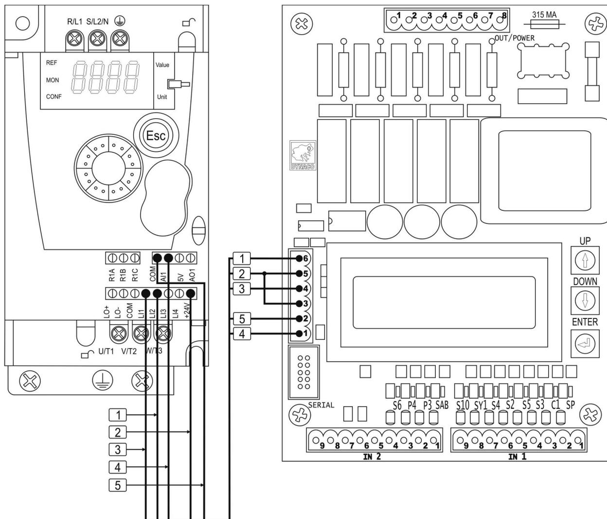
Рисунок 7-4. Соединение преобразователя частоты ATV12 и платы управления.
