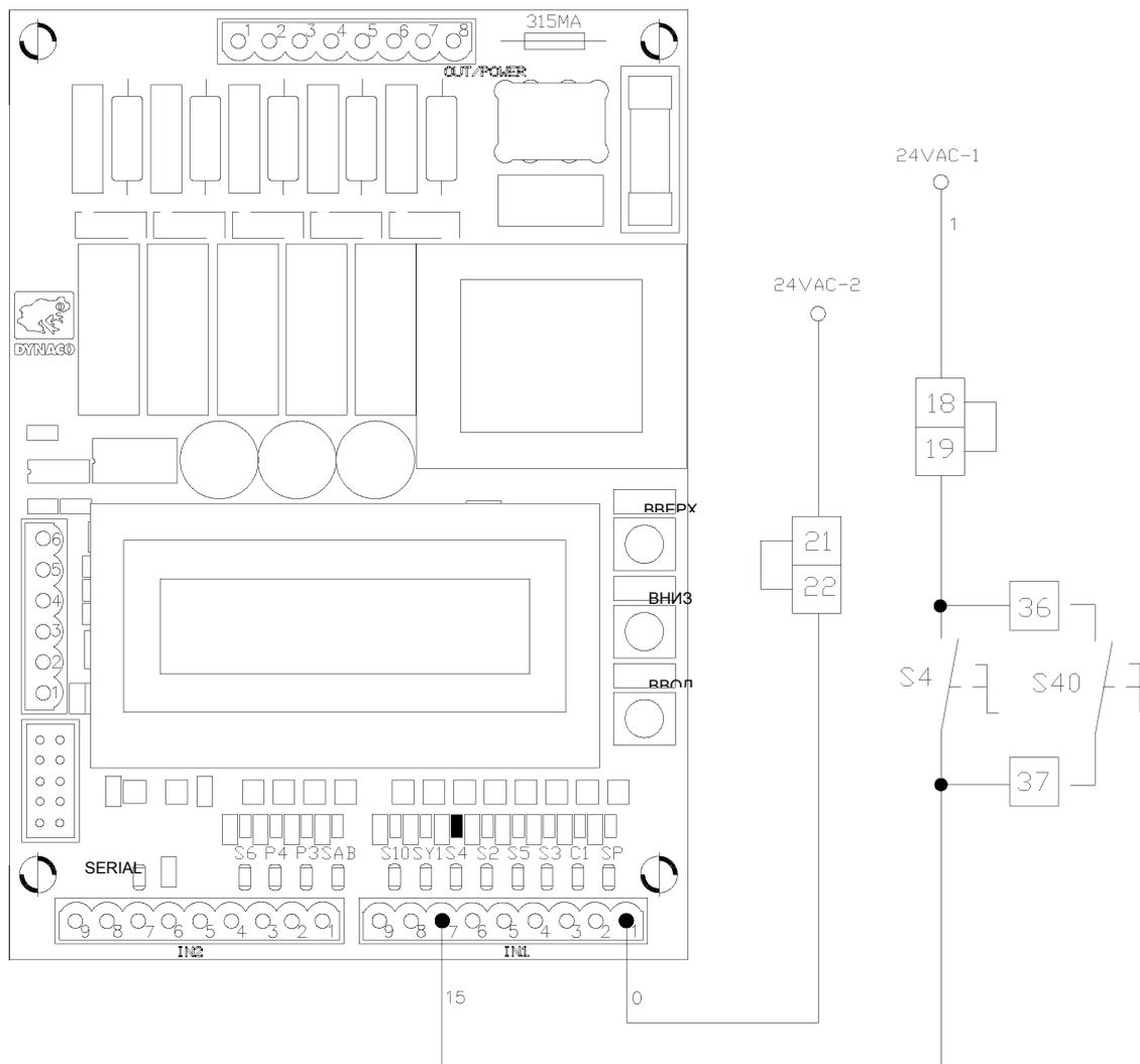
Рисунок 7-10. Соединение автом./ручн.
