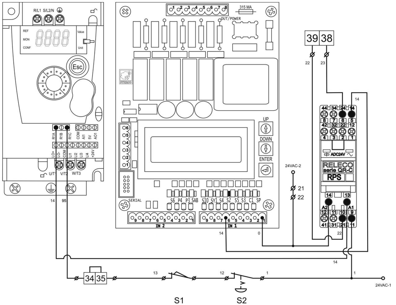
Рисунок 7-31. Подключение сигнала «ворота не работают RPS».
