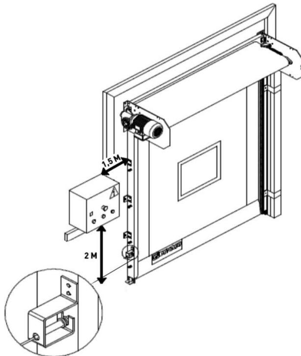
Рисунок 6-13. Установка фотодатчиков на модели Freezer
