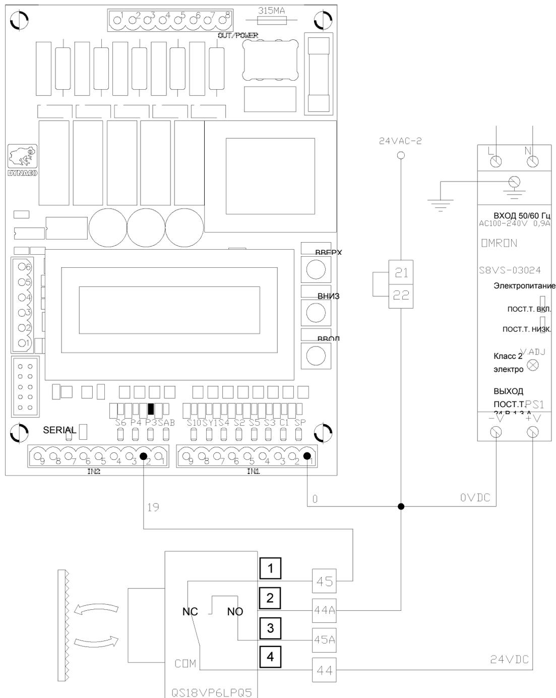
Рисунок 7-20. Соединение аварийного фотозлемента 2 в 1.
