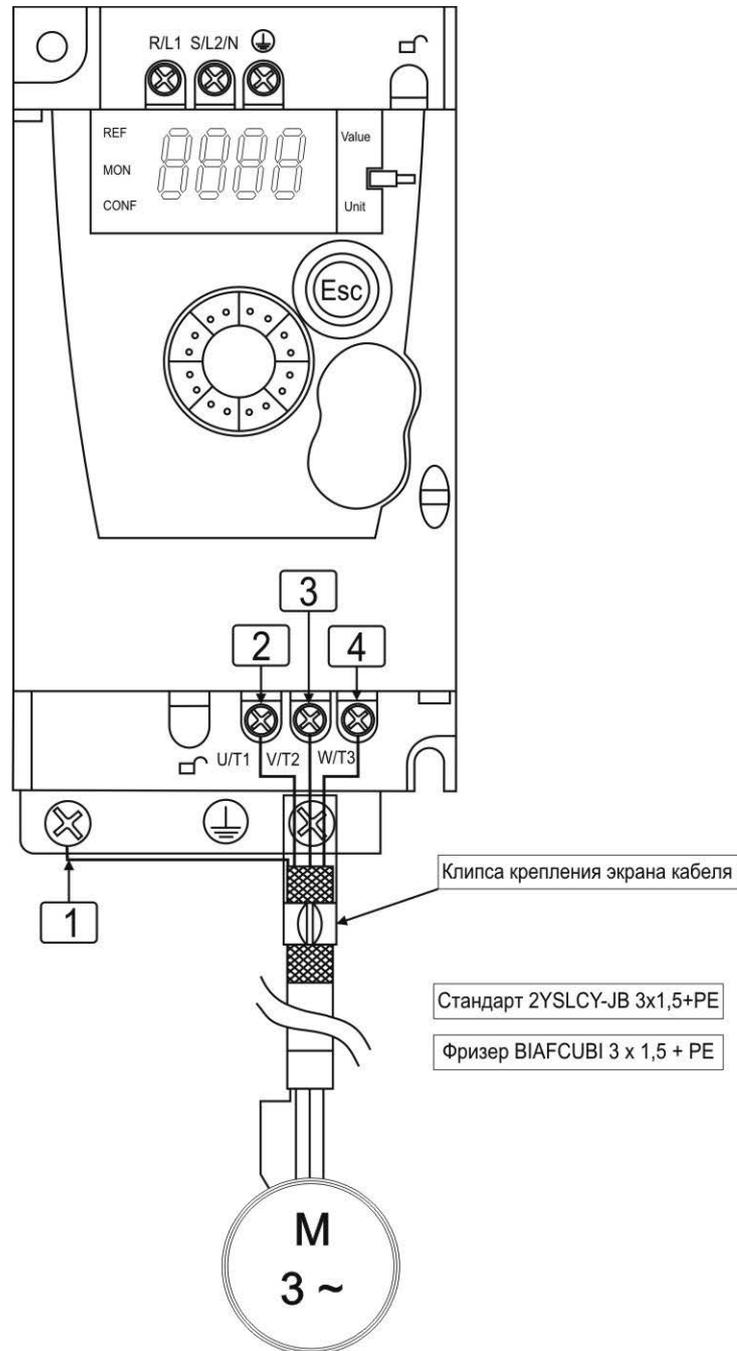
Рисунок 7-3. Подключение двигателя к ATV 12 для D311-M2-M3.
