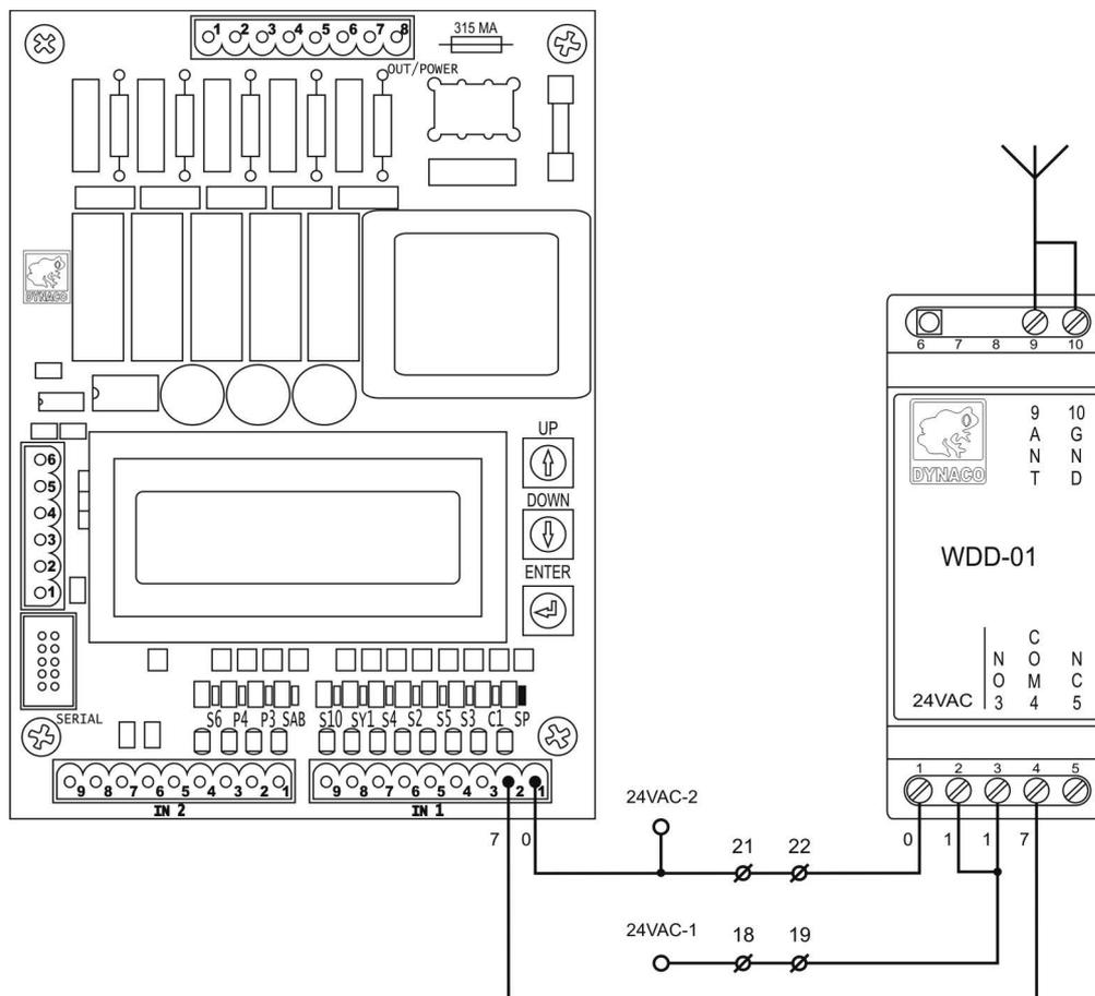
Рисунок 7-32. Подключение WDD.
