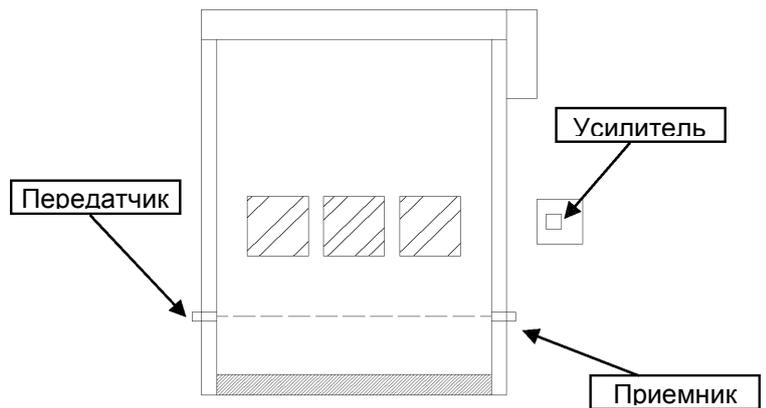
Рисунок 7-8. Фотоэлемент
