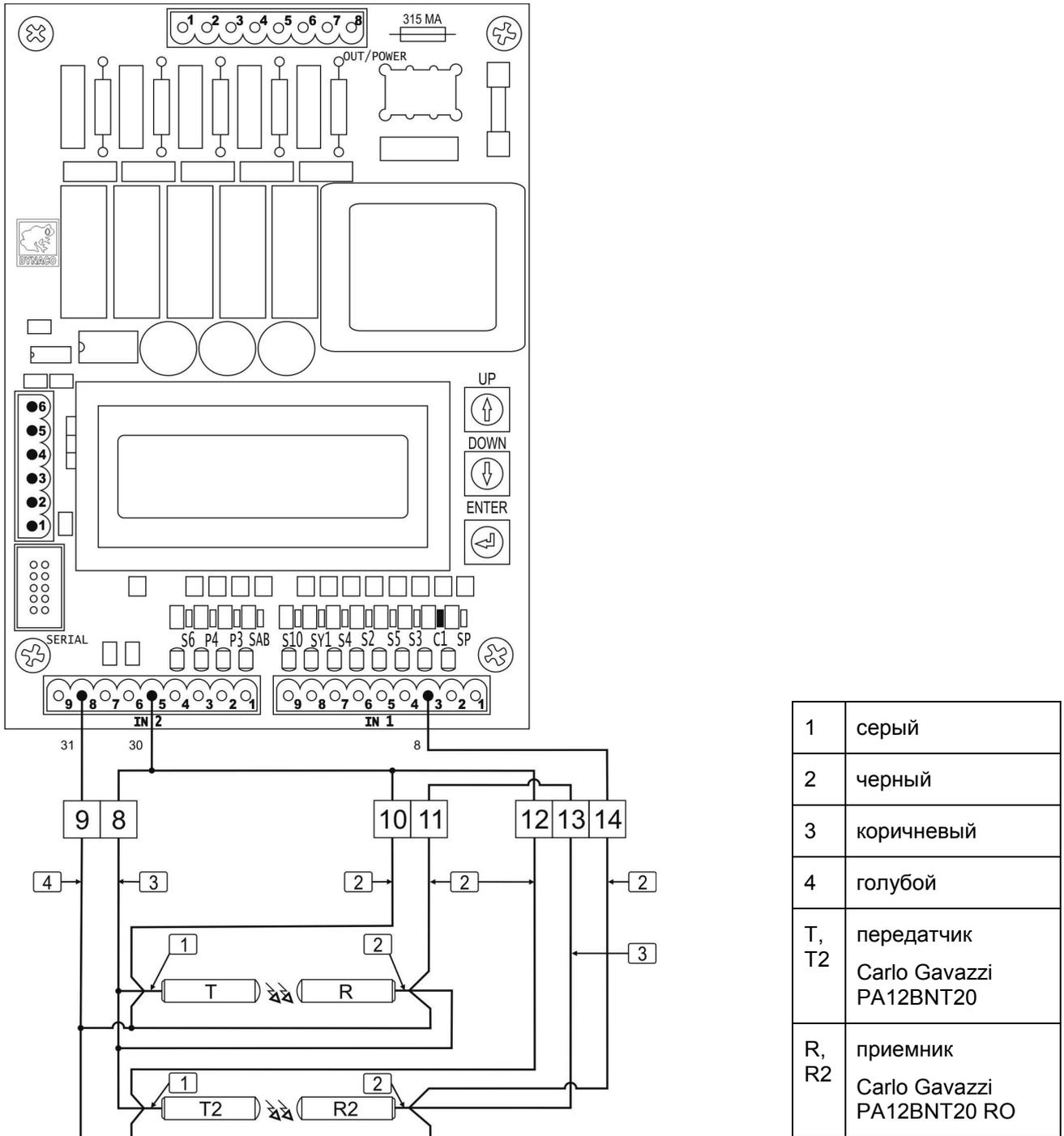
Рисунок 7-27. Подключение к плате управления пары фотоэлементов без усилителя.
