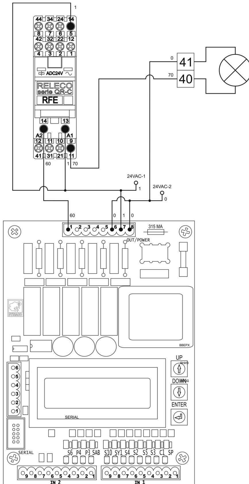
Рисунок 7-14. : Подключение мигающего маячка 24 В.
