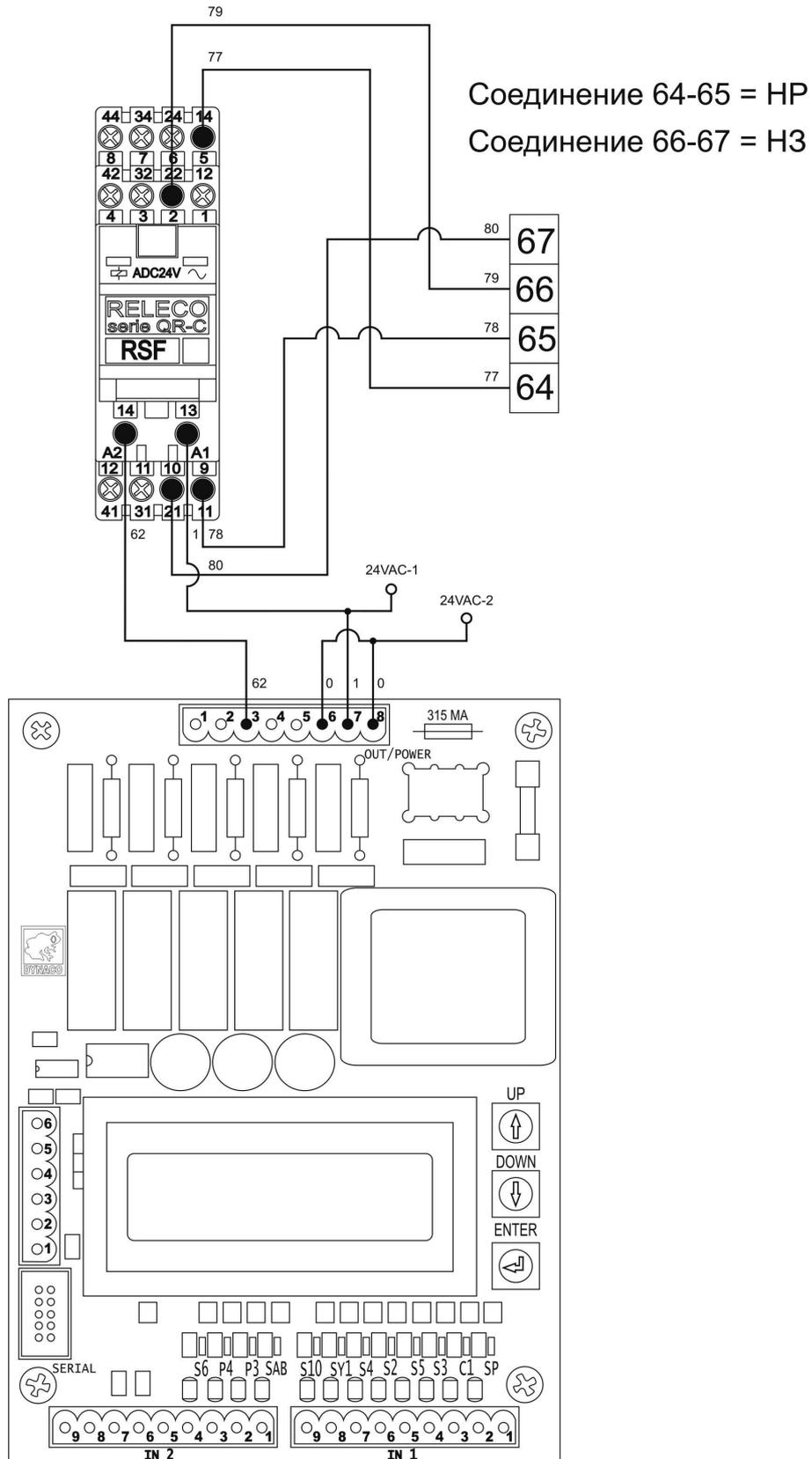
Рисунок 7-13. : Подключение сигнала «ворота закрыты» (опция).
