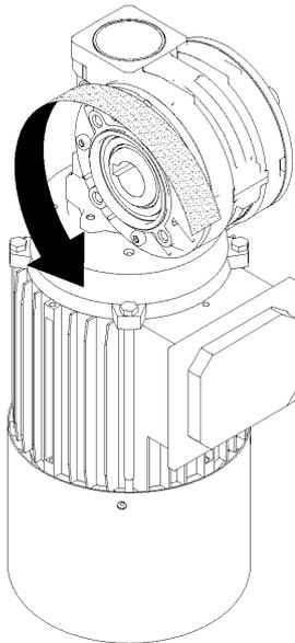
Рисунок 8-2. Направление вращения двигателя при закрывании ворот.
