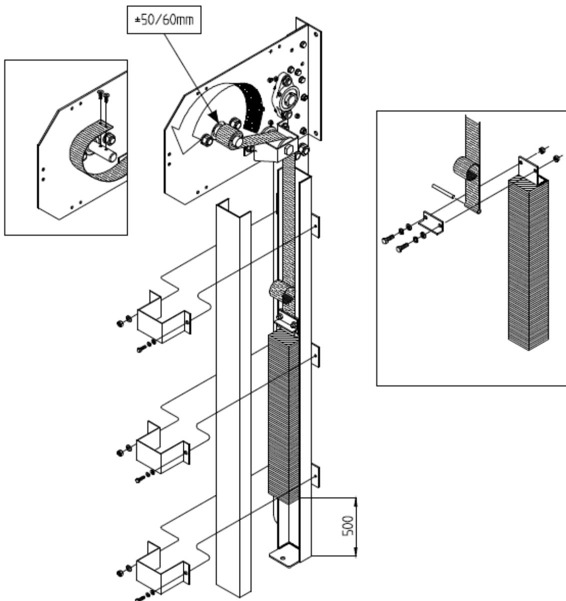
Рисунок 6-17. Старый тип монтажа и настройки противовеса.
