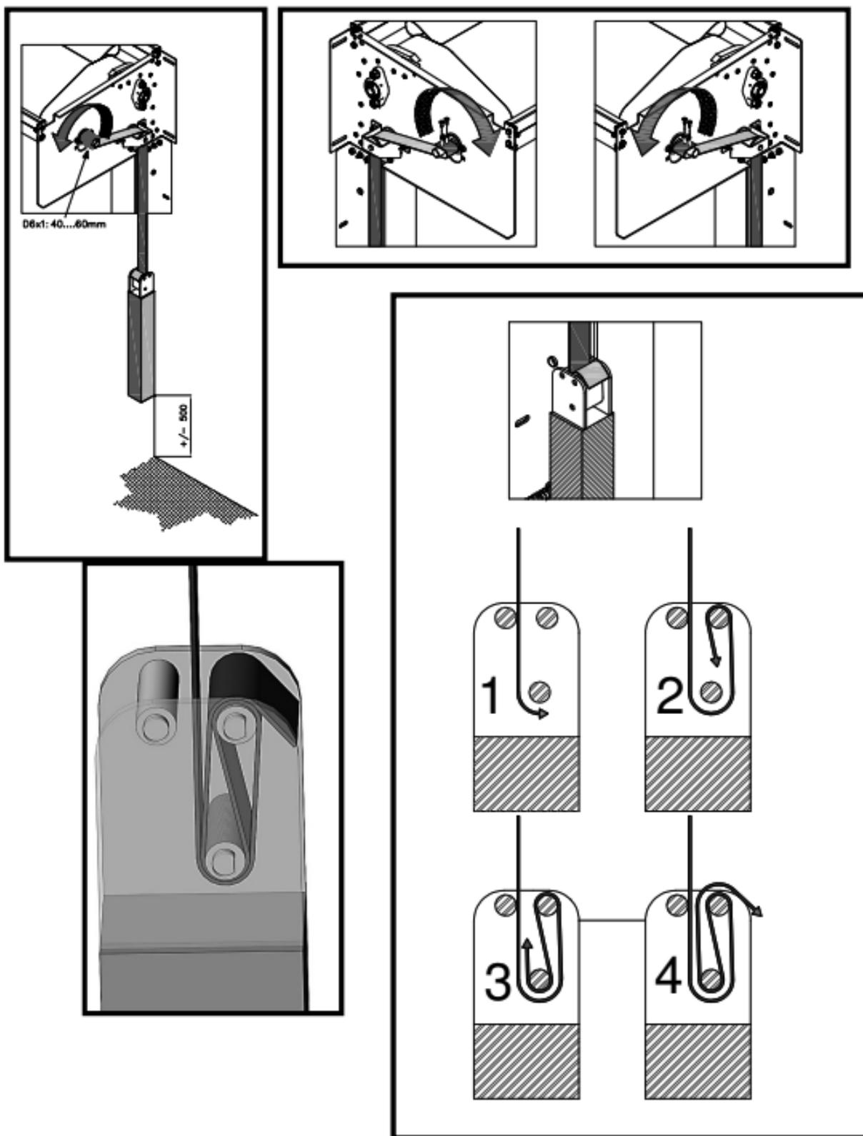
Рисунок 6-18. Новый тип монтажа и настройки противовеса.
