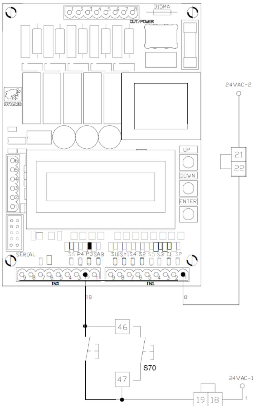
Рисунок 7-16. Подключение кнопки «вторая высота открывания».
