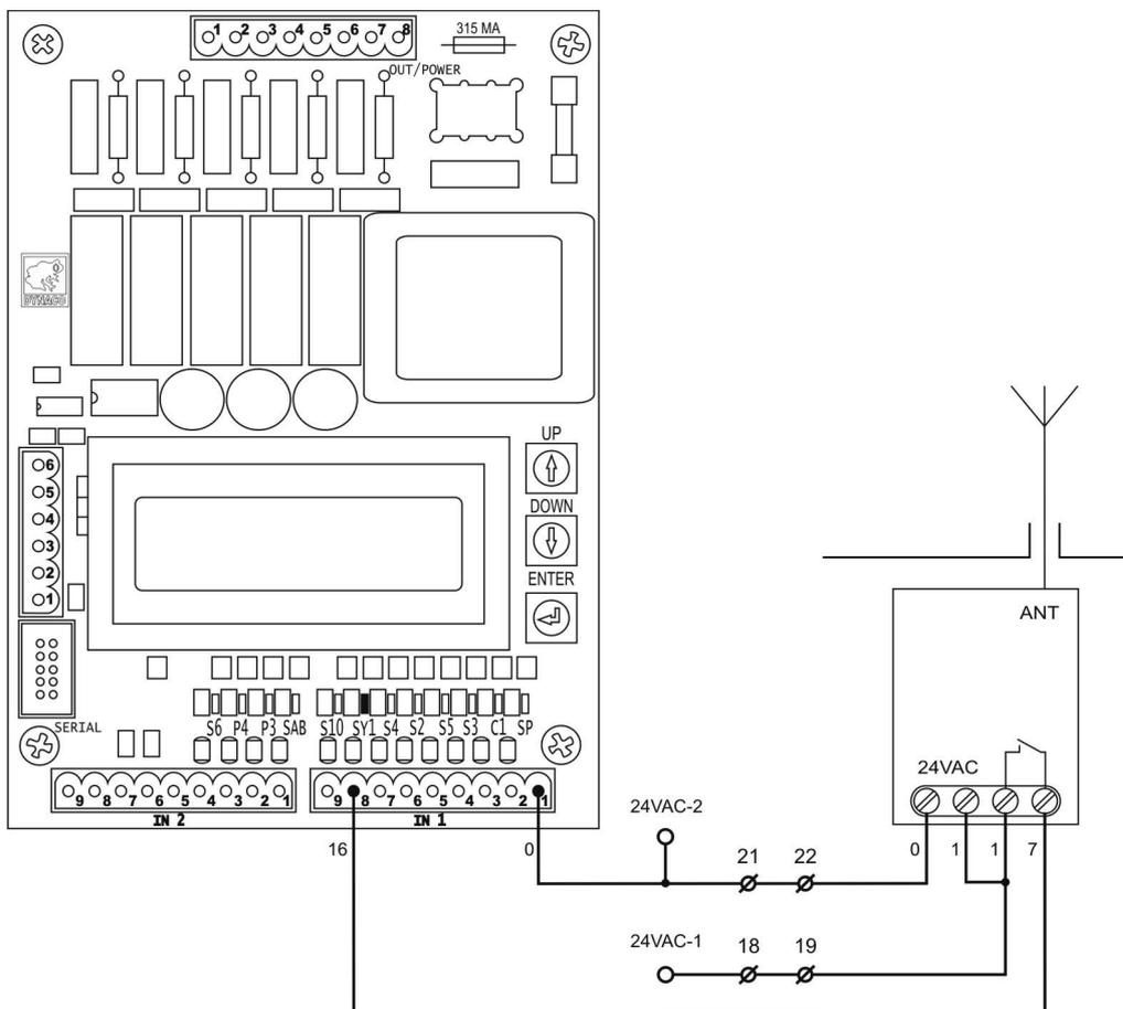
Рисунок 7-30. Подключение приёмника дистанционного управления REC1
