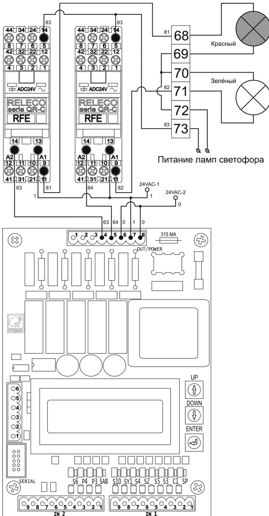
Рисунок 7-24. Подключение светофора с красным и зеленым светом.
