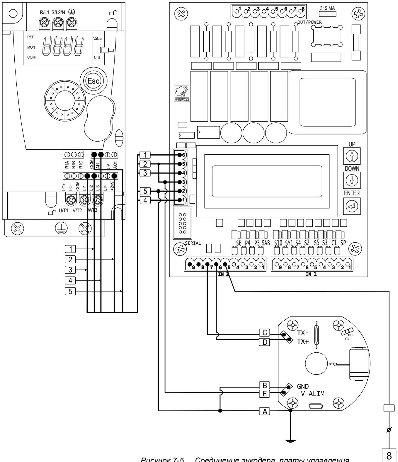
Рисунок 7-5. Соединение энкодера, платы управления и частотного преобразователя
