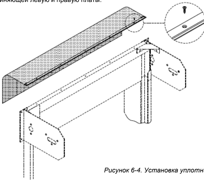
Рисунок 6-4. Установка уплотнительного полотна
