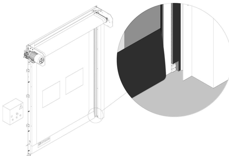
Рисунок 6-12. Положение zipper в закрытом состоянии ворот.
