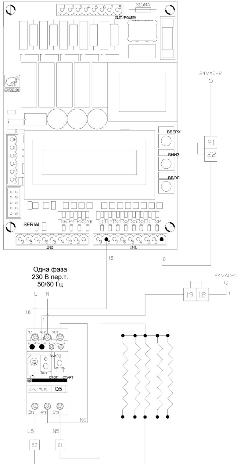
Рисунок 7-21. : Соединение кабелей обогрева (для модели Freezer).
