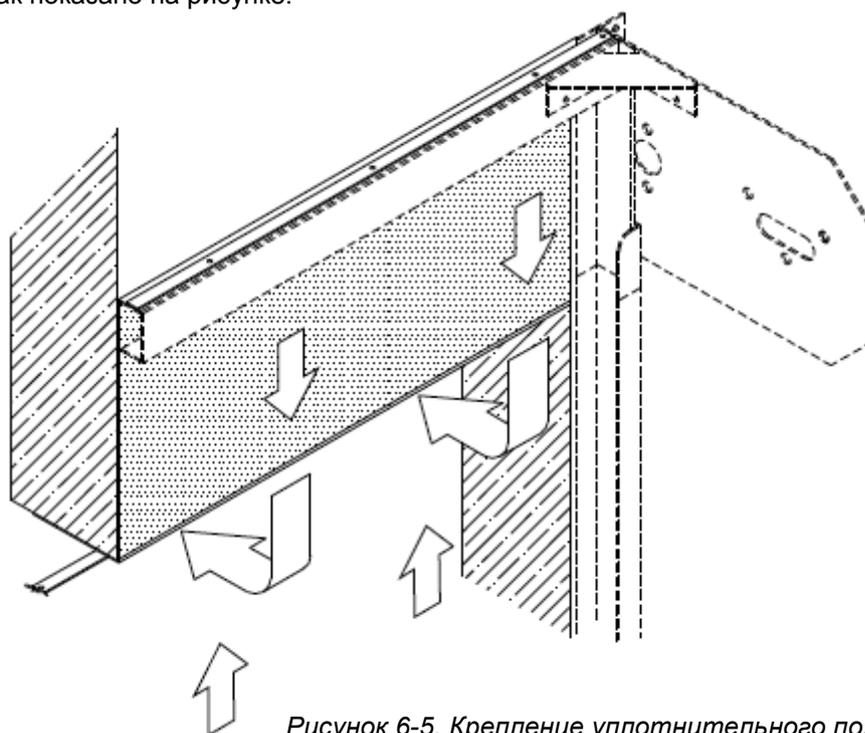
Рисунок 6-5. Крепление уплотнительного полотна на стене
