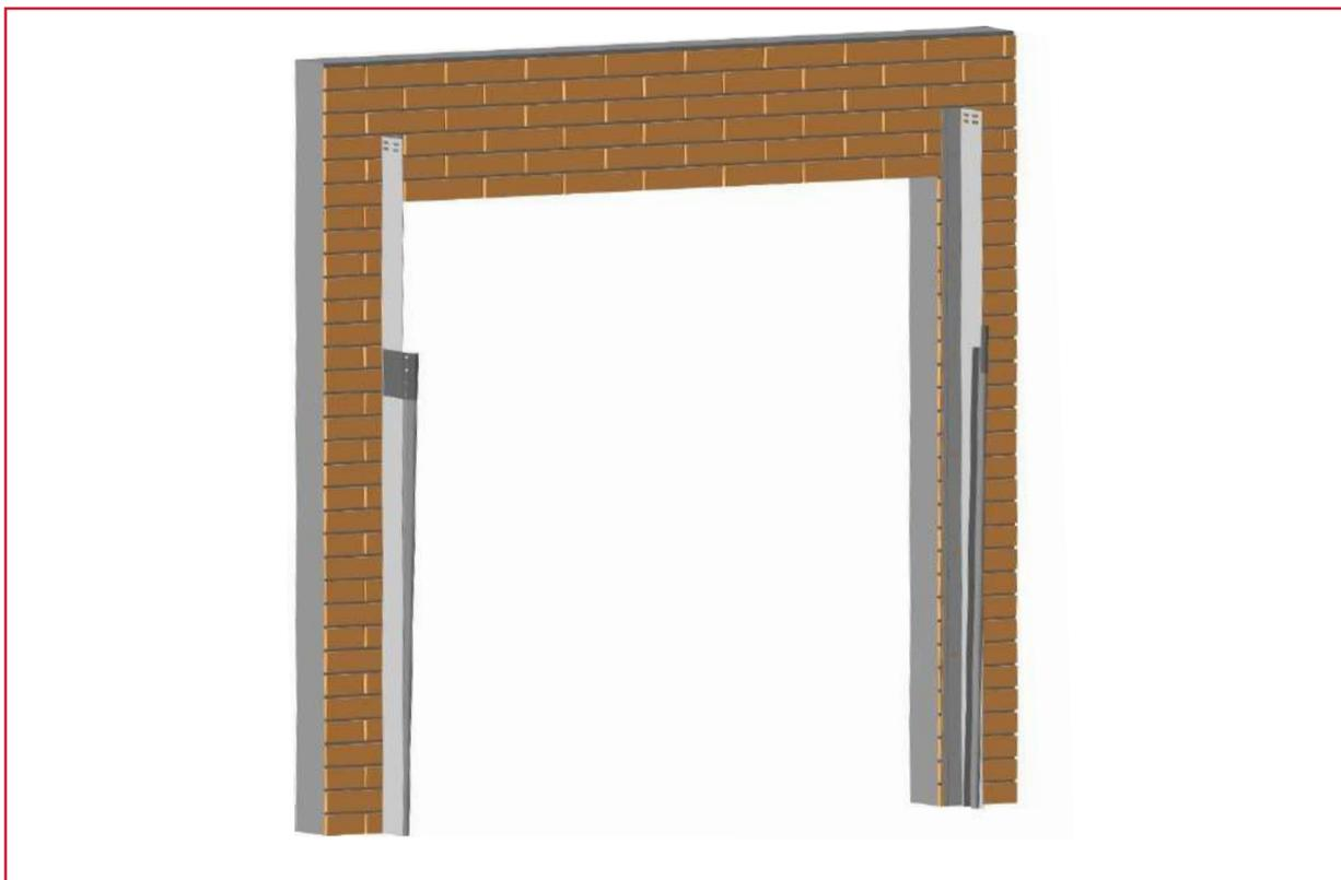
Рисунок 7. Общий вид установленных вертикальных направляющих
