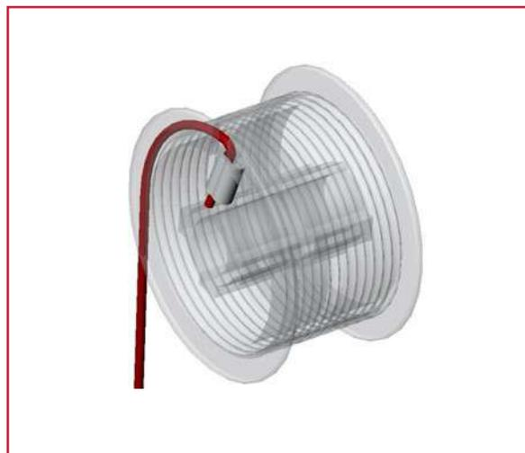
Рисунок 36. Крепление троса на барабан
